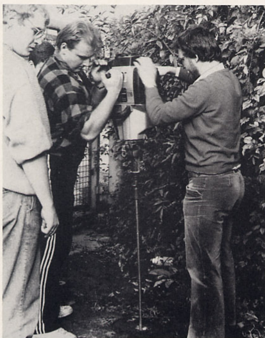
Foto oben: Flad-Schüler nehmen auf einem ehemaligen Fabrikgelände Bodenluftproben. Als erstes muß ein Loch von vier bis acht Meter Tiefe und etwa zwei bis drei Zentimeter Durchmesser in die Erde gebohrt werden.
