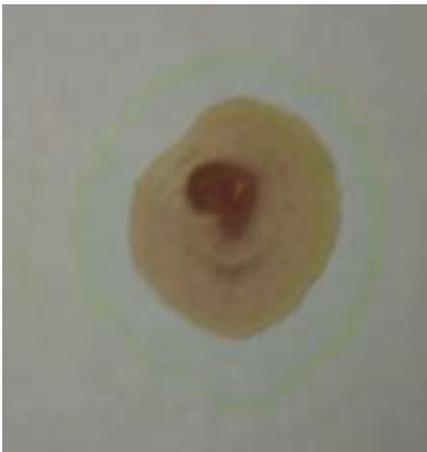
Um den dunkelbraunen Mittelfleck von Bild IV sind braune Ringe erkennbar, die ähnlich aussehen wie bei Bild I. Der Ring darum ist hellblau und der äußerste Ring ist farblos. Es sind keine Verästelungen erkennbar. Der farblose Ring ganz außen ist Natriumchlorid, dessen Lösung als erstes aufgetropft wurde. Der hellblaue Ring dazwischen ist Kupfersulfat, dessen Lösung als zweites aufgetropft wurde.
