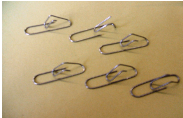
Abb. 15: Verbindungsstück zur Befestigung der Elektroden
