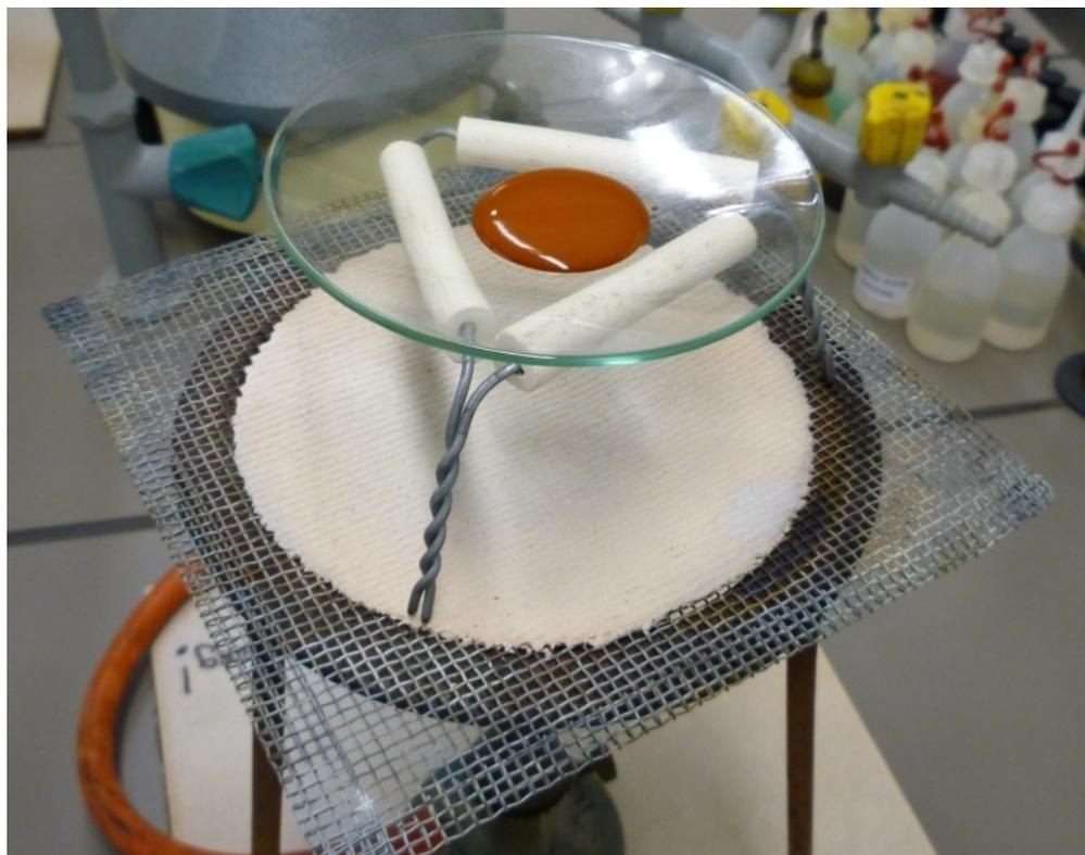
Abb.10: Abdampfen des Wassers der SPNC-Suspension
