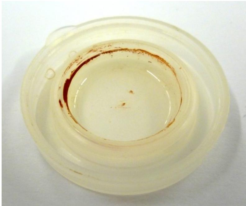
Abb.8: Rollrandglasdeckel als Beispiel für Verluste während des Versuchs
