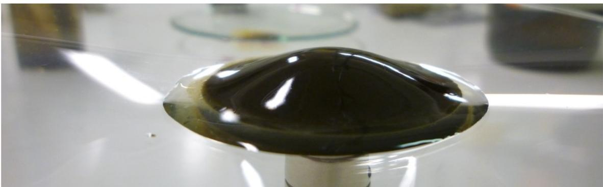
Abb.16: Selbsthergestelltes magnetisiertes Ferrofluid auf wässriger Basis
