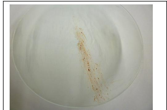
Abb.9: Trockene Nanopartikel auf einem oberflächenbehandeltem Uhrglas
