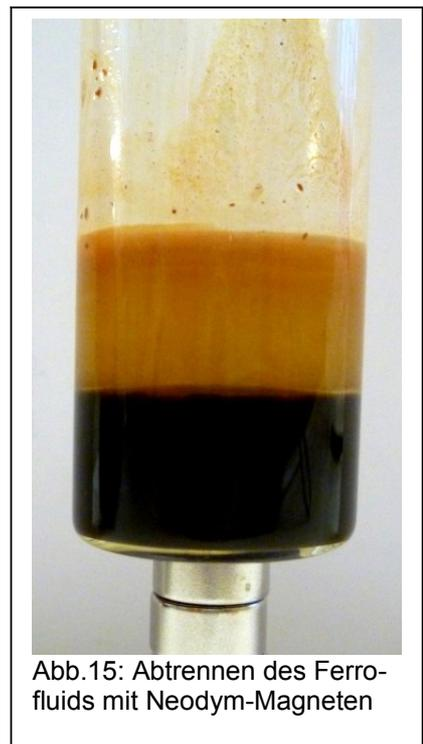
Abb.15: Abtrennen des Ferrofluids mit Neodym-Magneten
