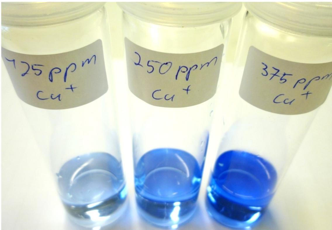
Abb.6: Verdünnungen der Kupferammin-Lösungen in Rollrandgläsern vor der Kupferabtrennung
