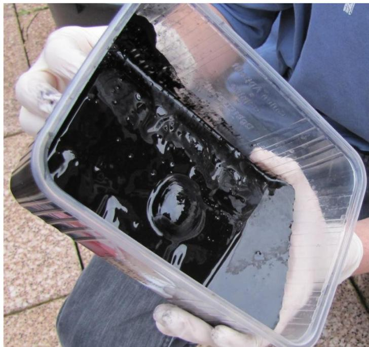
Abb.23: Ferrofluid aus Druckertoner mit magnetisierter Stelle
